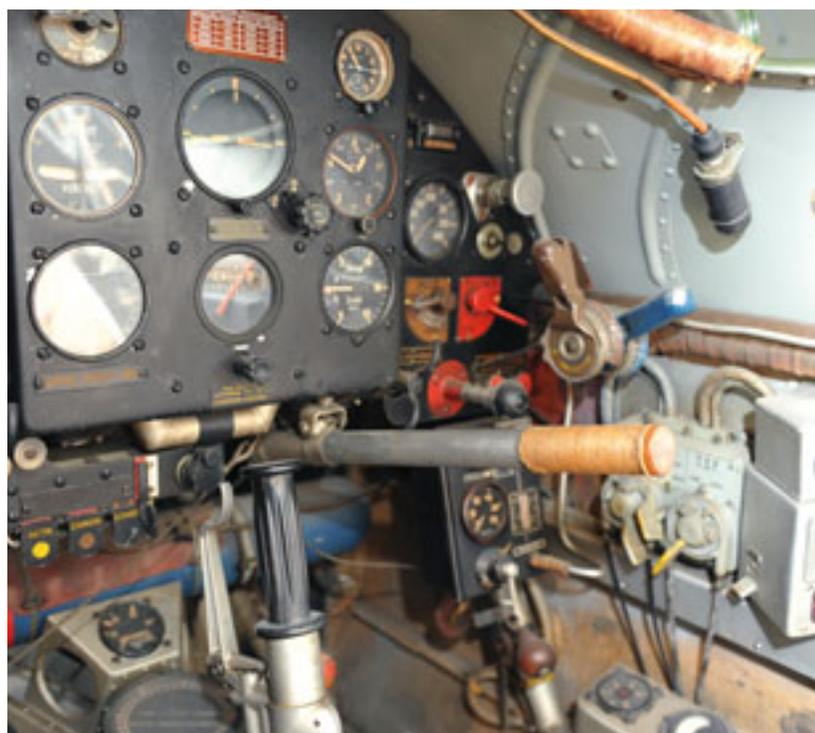
*Knebel für Bedienung der Radbremse*
