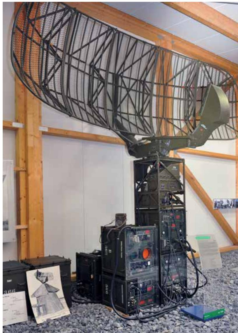
von sechs Mann getragen, oder mit einem Zweiradtransportkarren bewegt werden. Für den Einsatz wurden die sechs Einheiten und die Antenne zusammengebaut. Als Schutz des Gerätes diente ein Zelt.
